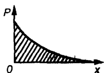
Рис. 4.9 Концентрация неосновных носителей вблизи p-n перехода
